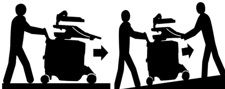
Рисунок 2-1 Перемещение системы по ровным и наклонным поверхностям
