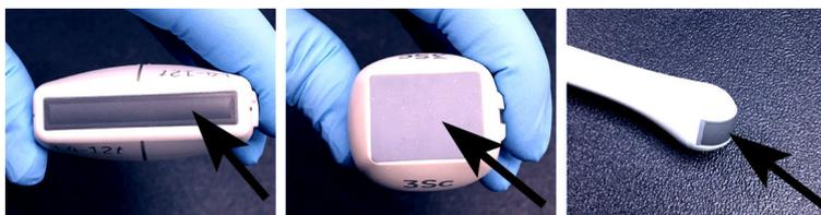
Рисунок 5-5 Примеры линз датчика
