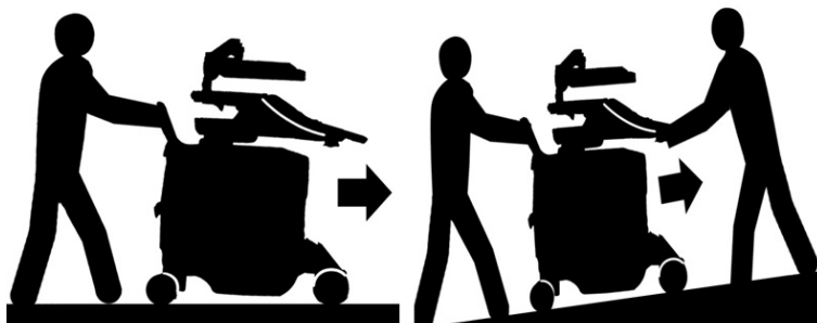
Малюнок 2-1 Переміщення системи по рівній і нахиленій поверхні
