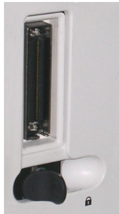
Рис. 13-3. Рычаг фиксации разъема датчика типа RS
