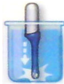
Рис. 13-14. Датчик, окруженный дезинфицирующим раствором в емкости
