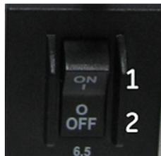
Рис. 1-12. Автоматический выключатель (размещенный на задней панели системы)
