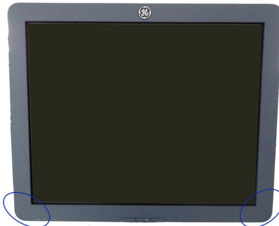
Рис. 1-7. Возьмитесь за нижнюю часть ЖК-монитора
