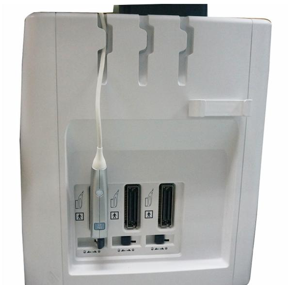
Рис. 1-17. Подключения кабеля датчика
