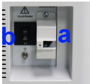
Рис. 1-10. Выключатель и вилка питания
