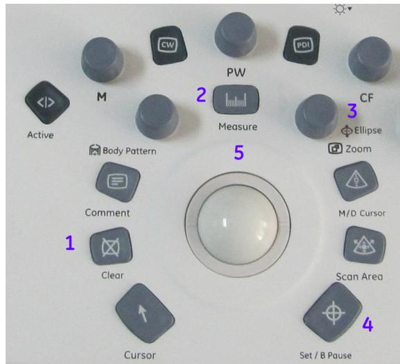
Рис. 2-26. Местоположение элементов управления измерением
