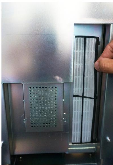
Рис. 3-21. Извлечение фильтров
