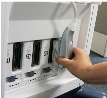
Рис. 1-15. Подсоединение датчика.
