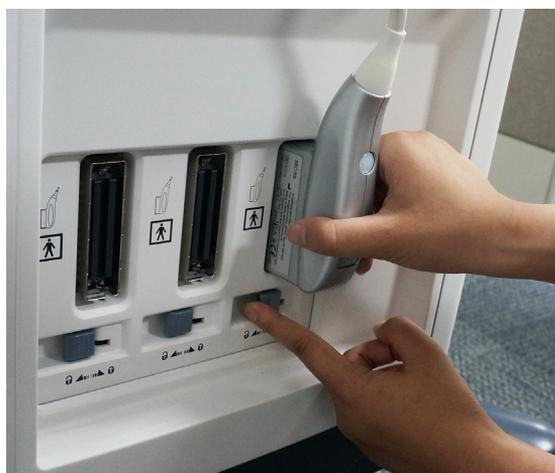
Рис. 1-16. Заблокируйте разъем датчика
