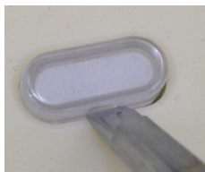
Малюнок 1-28. Зніміть клавішний ковпачок.
