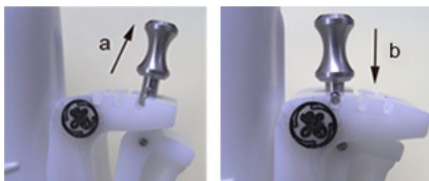
Малюнок 1-40. Потягніть ручку догори, а тоді натисніть на неї.
