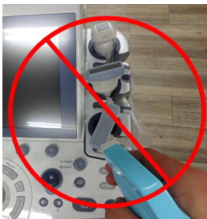
Малюнок 3-38. НЕ ДОЗВОЛЯЄТЬСЯ розпилювати препарат на датчик, який знаходиться у тримачі
