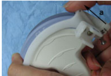
Малюнок 1-48. Від'єднайте напрямну для біопсії
