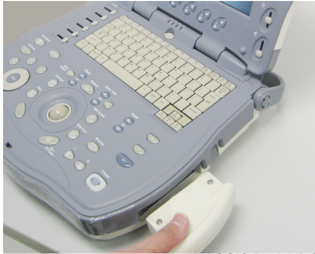
Рис. 1-11. Подсоединение датчика к LOGIQ Book XP Series
