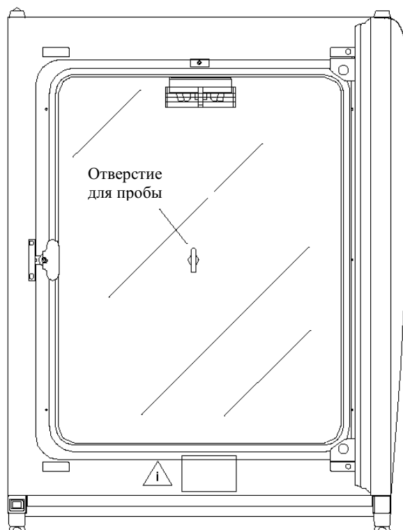
Рис. 13 Сличение CO 2 , отверстие доступа для взятия проб
